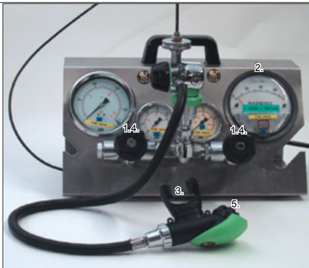
**ADJUST THE 2<sup>ND</sup> STAGE TO 28-40 MM.W.C.**
